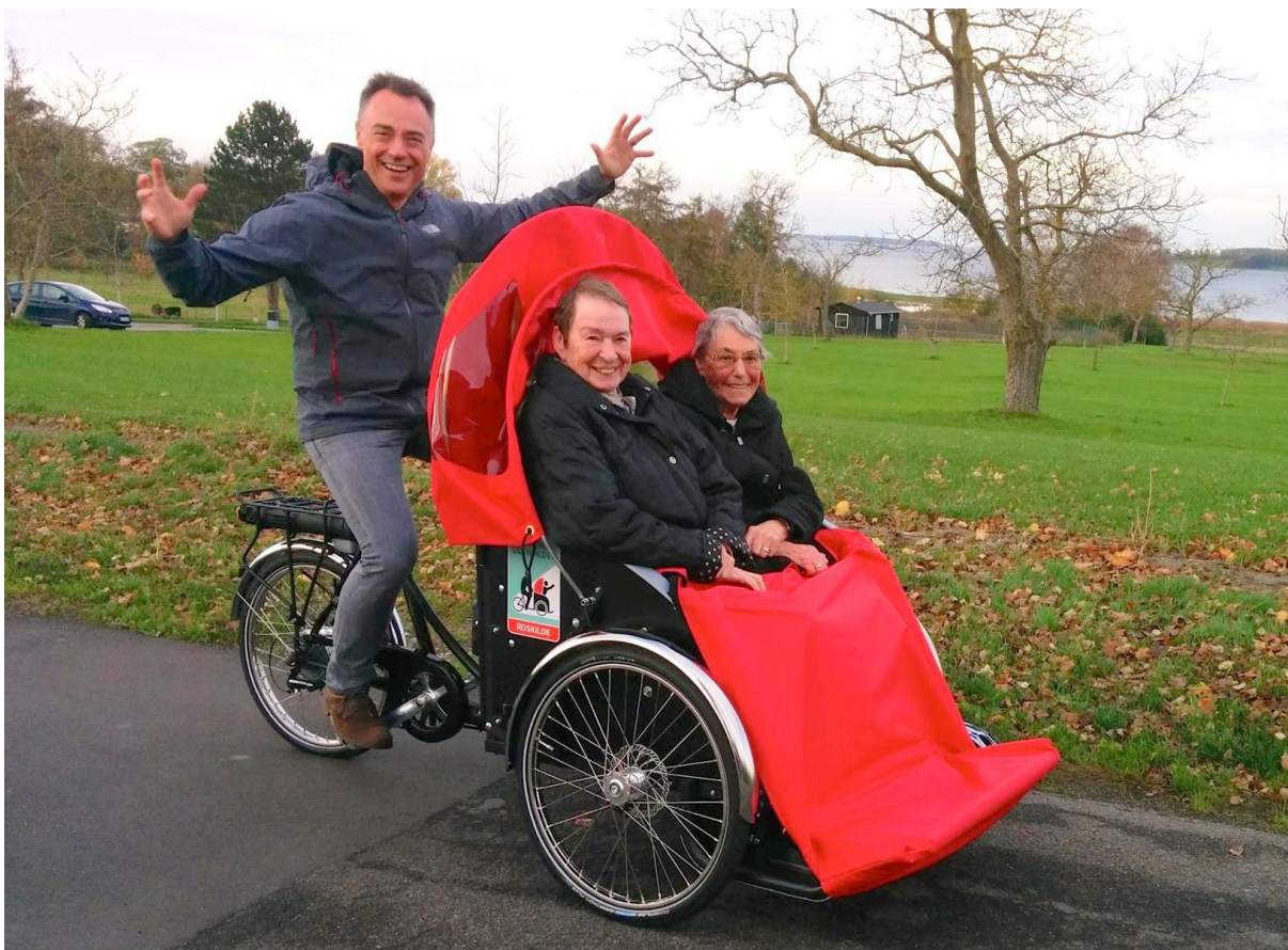
Tillatt motorassistanse på denne trehjulingen med tre sitteplasser er 0,5 kW. Foto: Sykling uten alder - Norge
