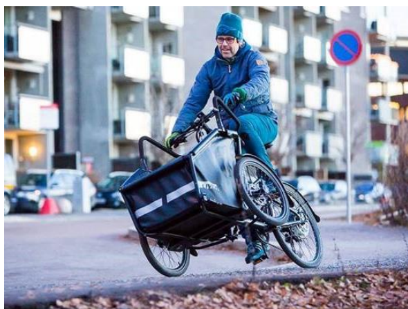
Bildet til venstre viser trehjuls lastesykkel som overstyres ved sving i høy hastighet. Bildet til høyre viser trehjuling som krenger. Foto: f/v Eskil Møller Ørslie, f/h Foto: EVO Elsykler - evoelsykler.no
